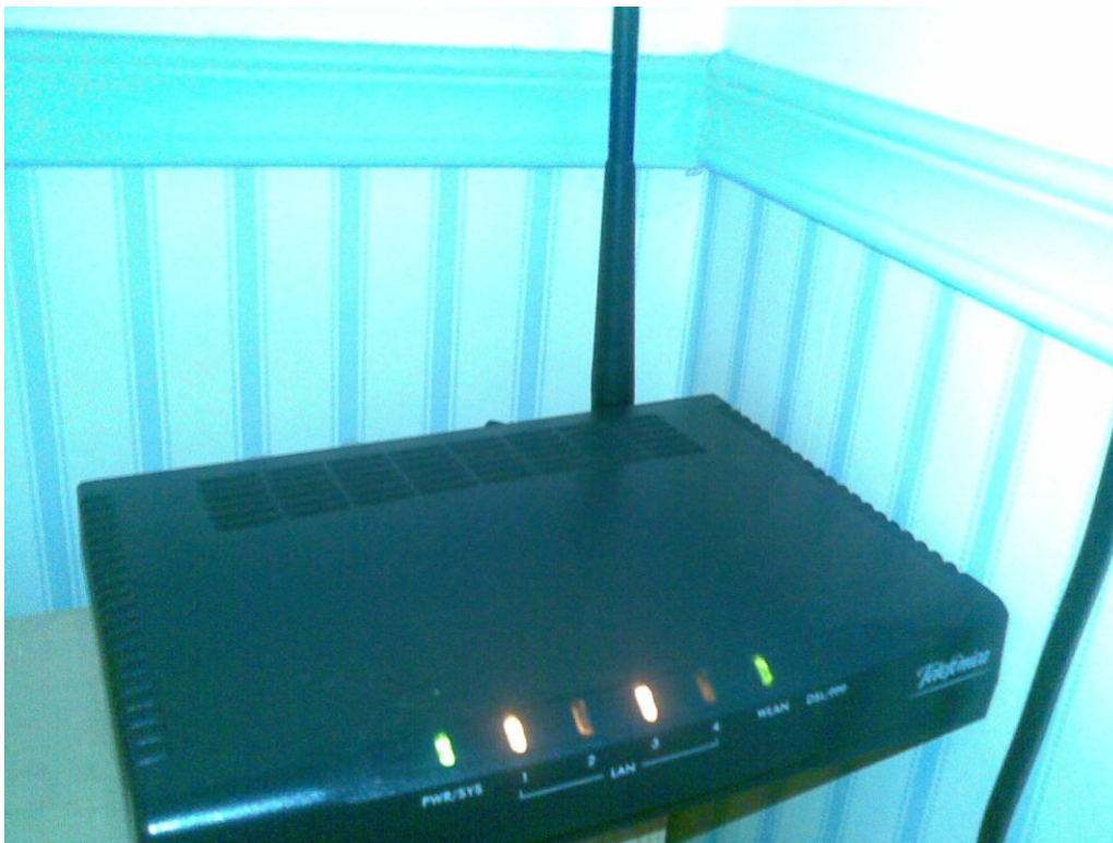
ROUTER INALAMBICO (Véase la Antena Junto a la misma tiene 4 puertos Hembras RJ45)
