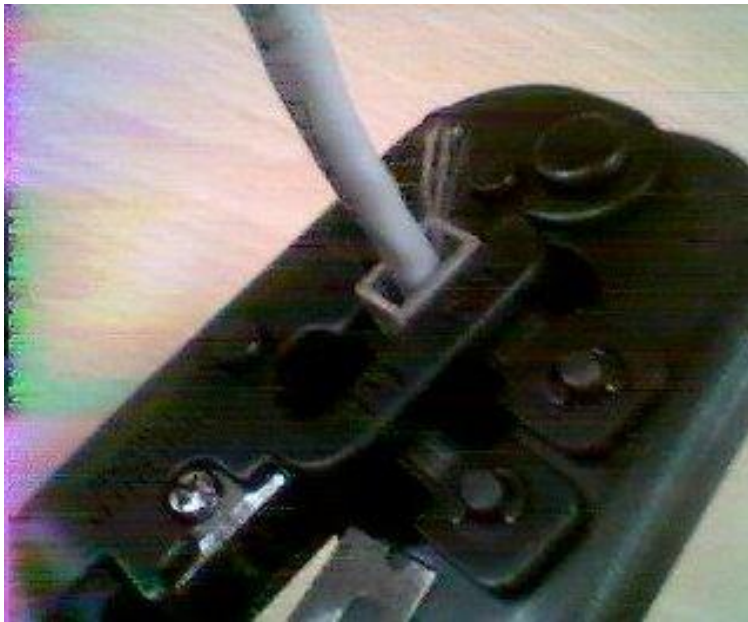
Vista del conector RJ45 introducido en el alicate para su fijación al cable
